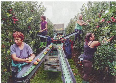
Pluk-O-Trak nennt sich die Maschine, mit der die Helfer auf der Obstplantage Bloemersheim rund 1000 Kilogramm Äpfel pro Stunde in die Holzkisten legen können.
